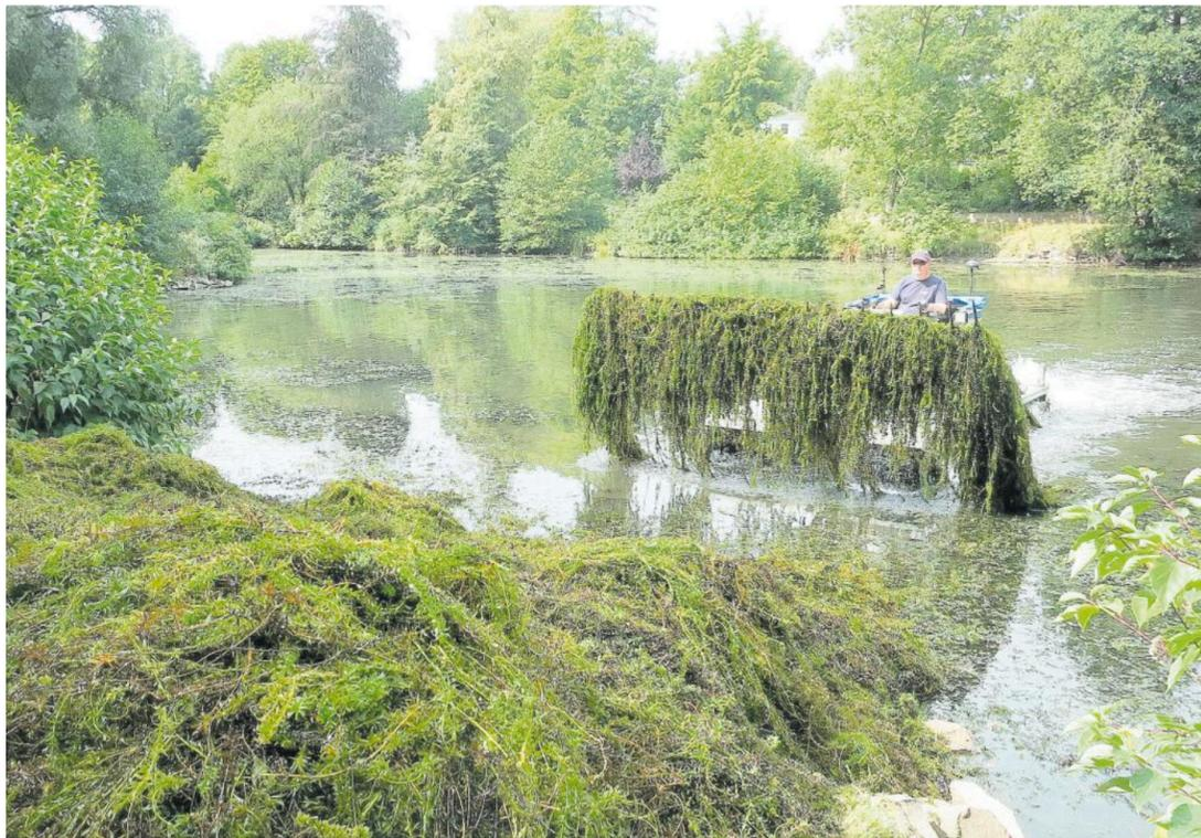
Alexander Ehlen steuert das Amphibienfahrzeug, das erst die Wasserpest am Grund des Stadtparkteiches abgemäht hat. Beim zweiten Durchgang wurden die an der Oberfläche schwimmenden Pflanzen dann eingesammelt und ans Ufer gebracht. Foto: Karsten Mittelstädt
